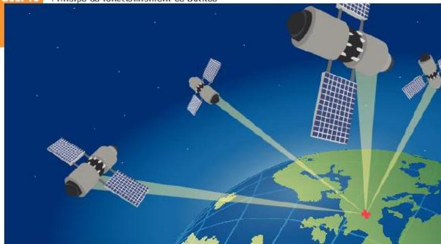
➔ Le **positionnement par satellite** repose sur la « trilatération » ou positionnement à une distance précise de trois points dont les positions sont connues.
